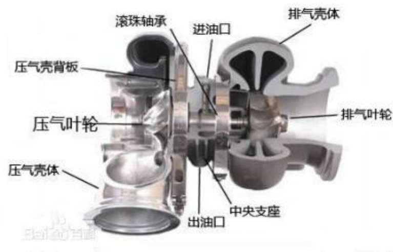
单涡轮增压系统示意图
