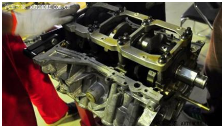
指导技师讲解螺栓的装配顺序和注意事项
