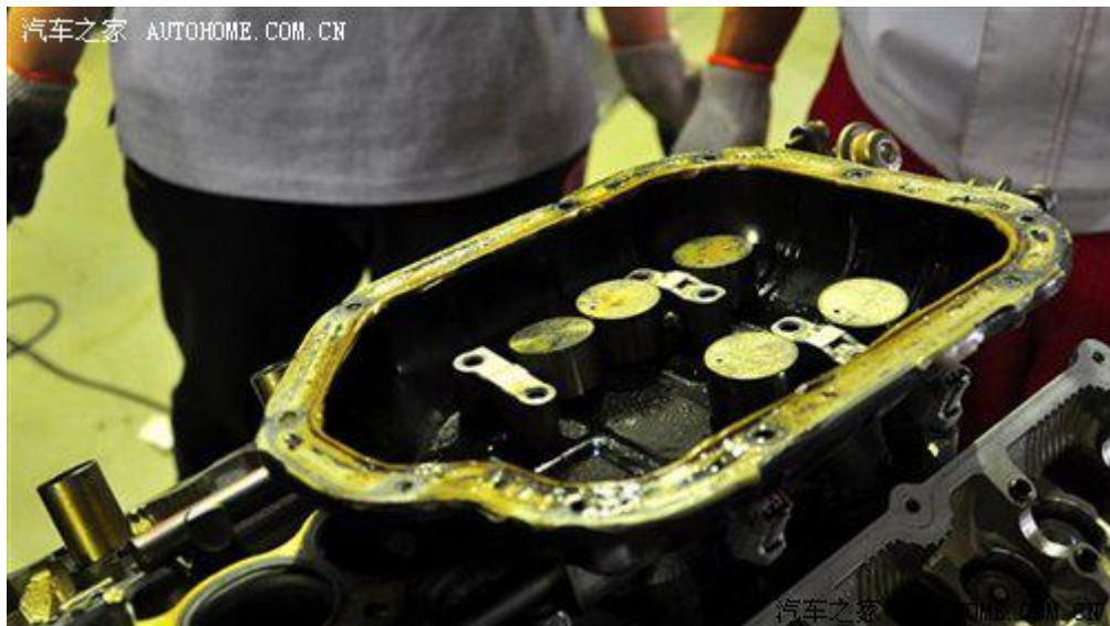
将液压挺柱取出，准备安装
