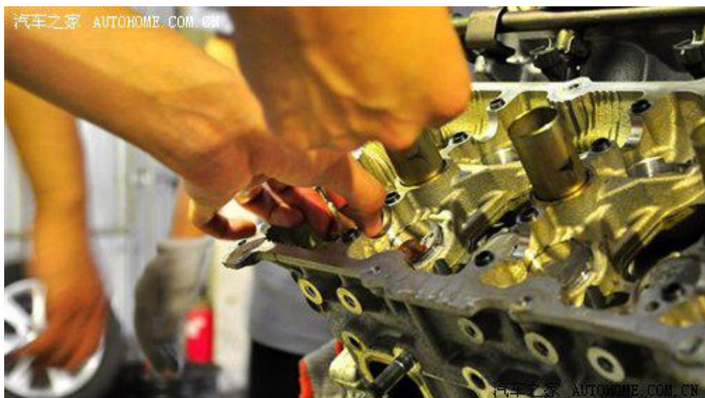
润滑后装入，这道工序由于要求比较精细，只能直接用手
