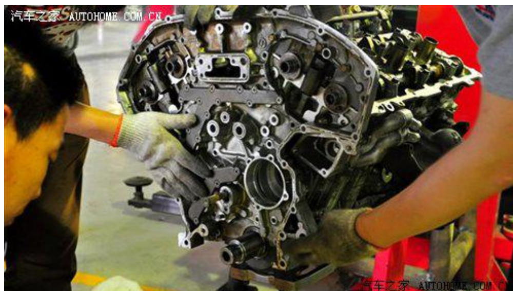
安装正时部分下盖
