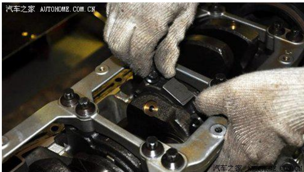
活塞顶到位之后，装上连杆盖，便完成一个活塞的装配
