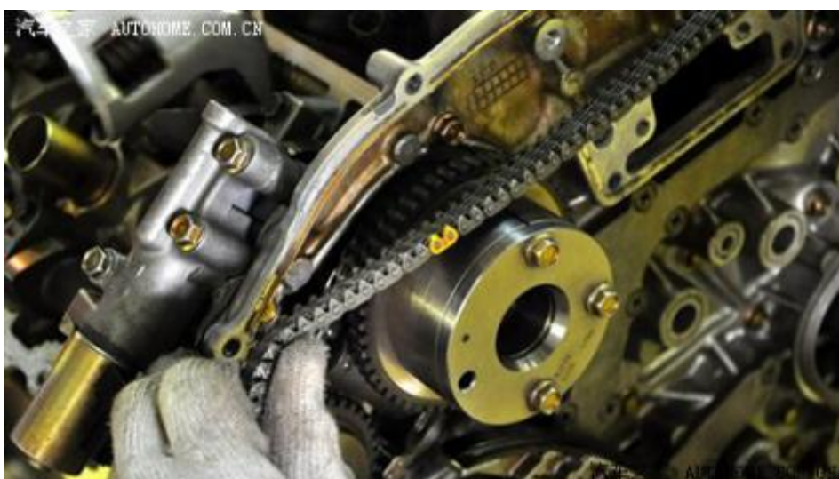
校正正时链条位置（注意链条上的黄色标记，是安装时的参考点）
