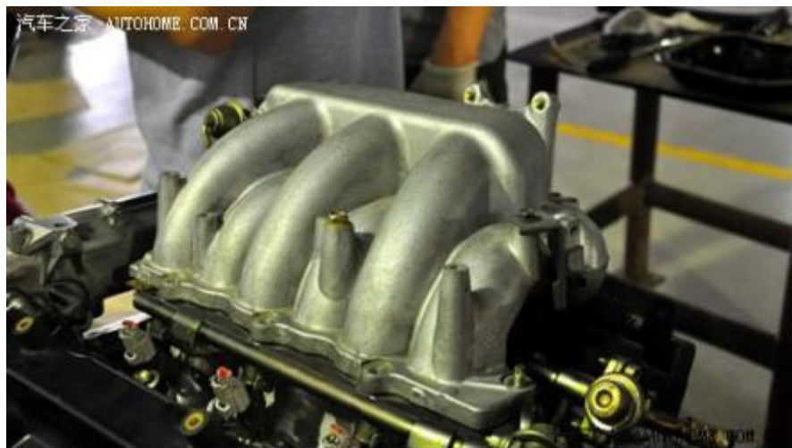
进气歧管安装完毕
