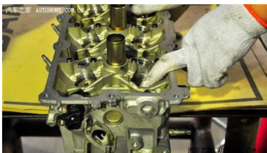
左侧缸垫尚未安装，右侧缸垫已经安装到位
