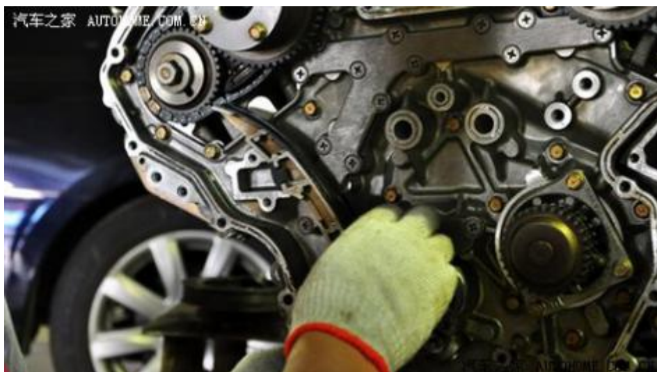
安装正时链条张紧器滑块
