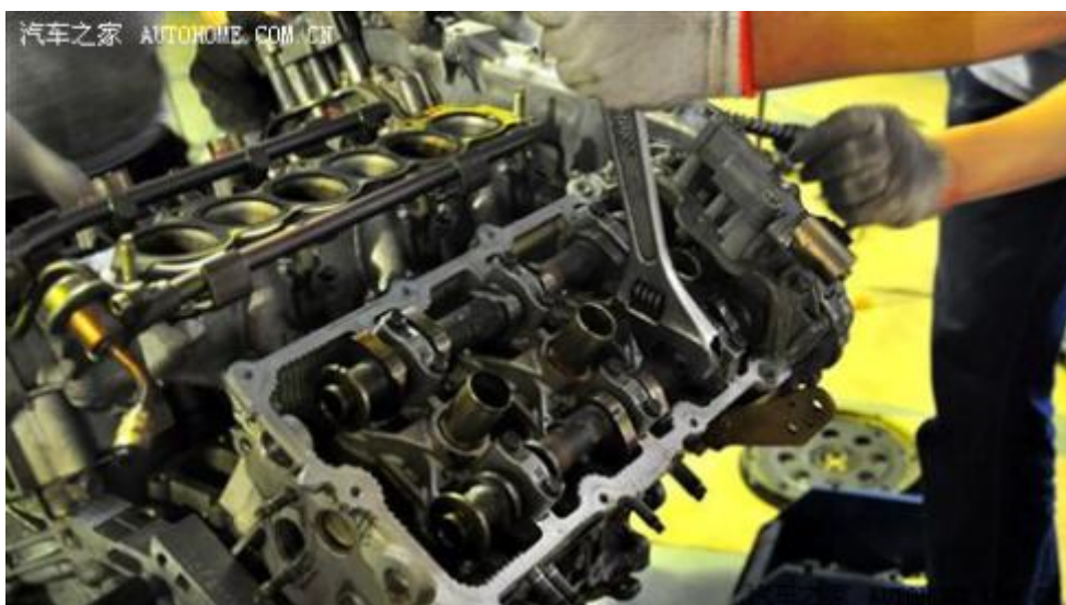
转动凸轮轴让链条走到适当位置
