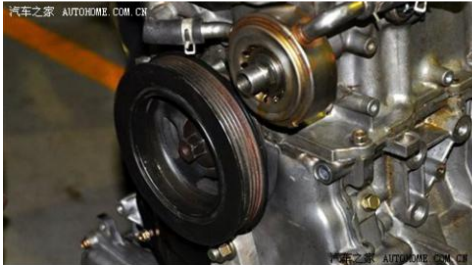
安装惰轮（它可以通过皮带带动助力泵、发电机、空调压缩机等）
