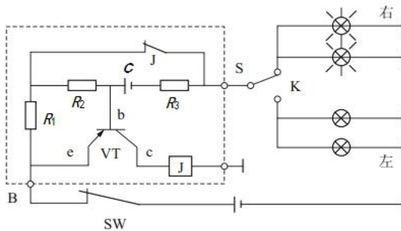
图 3 广州本田三厢飞度轿车转向灯工作电路
