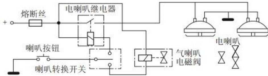
图 1 中、重型载货汽车安装的电气喇叭转换电路
