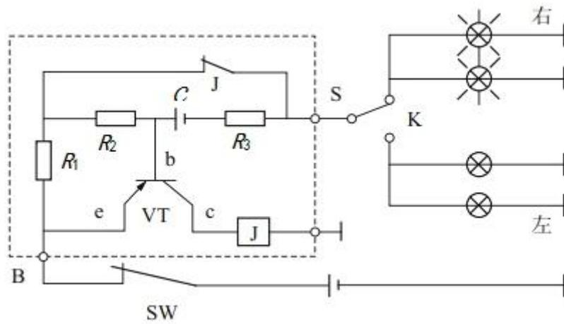
图 2 有继电器的晶体管式闪光等电路
